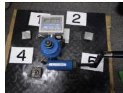
サンプルを用いた付着力試験
