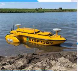
音響測深機器による 深淺測量
