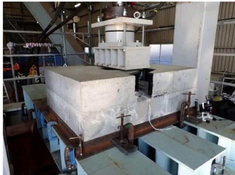
写真 5.1.1 静的載荷試験状況
