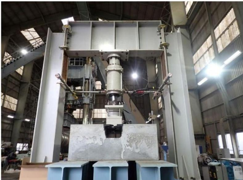
写真 3.1 500kN 疲労試験機
