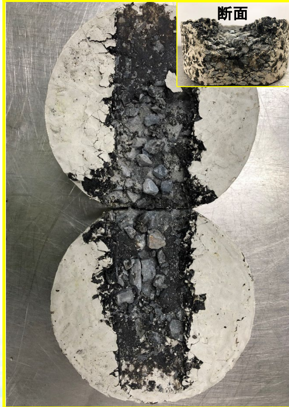
半たわみ性舗装
