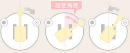
設定角度で自動的にレバーを中立に戻し、再び旋回可能
