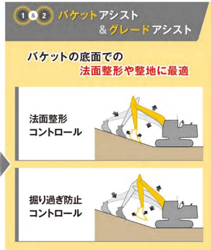
油圧ショベル（13t以上）のコンソール型は2D/3Dのマシンコントロールに対応
