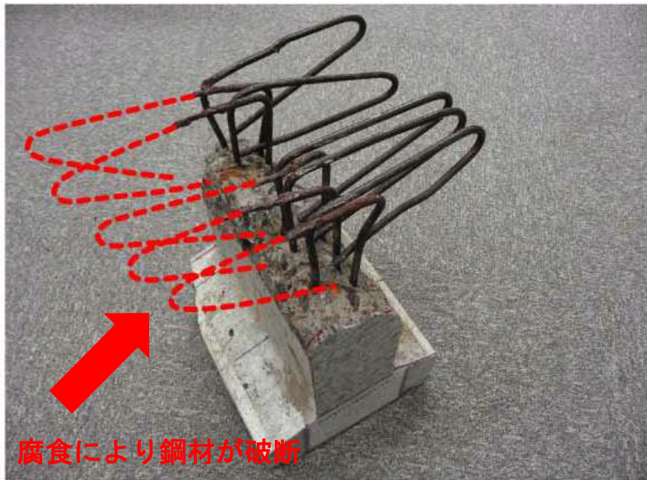
無防食状態のコンクリート中の鋼材
