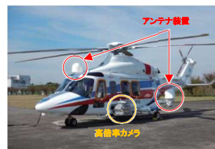
ヘリサットの通信設備(屋外)
