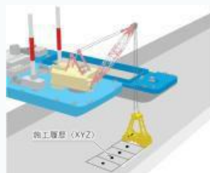
施工履歴データを用いた出来形計測 (左:機械均し(基礎工)、右:グラブ浚渫船(床掘工))
